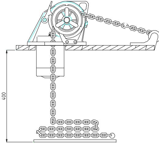
S'assurer que rien ne gêne sur le pont, qu'il y a suffisamment de place et que la manivelle (352) pourra être utilisée facilement. Afin de faciliter l'entretien du guindeau, Lofrans' conseille d'installer le guindeau sur une planche amovible qui est fixée sur le pont à l'aide de boulons/écrous. Si le pont n'est pas assez épais ou pas assez solide il sera nécessaire d'utiliser une contre-plaque (contre-plaqué ou bois) de taille suffisante pour étaler la charge pendant la remontée de la chaîne.
